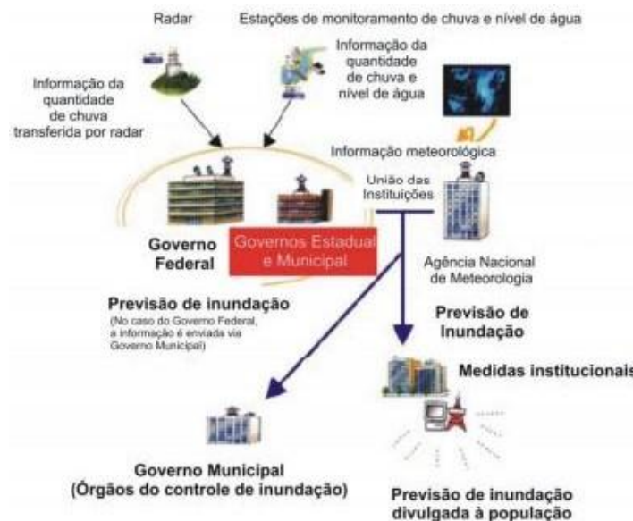
Figura 39 - Estrutura esquemática de uma rede de monitoramento e previsão de alerta.
