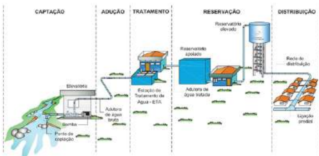
Figura 1 – Esquema ilustrativo de um Sistema de Abastecimento de Água (SAA)
