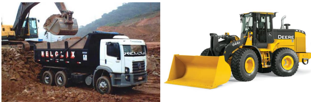
Figura 19 – Caminhão Basculante (direita) e Pá-carregadeira (esquerda) Fonte: (Soluções Industriais, 2021) e (Veneza Equipamentos, 2021).
